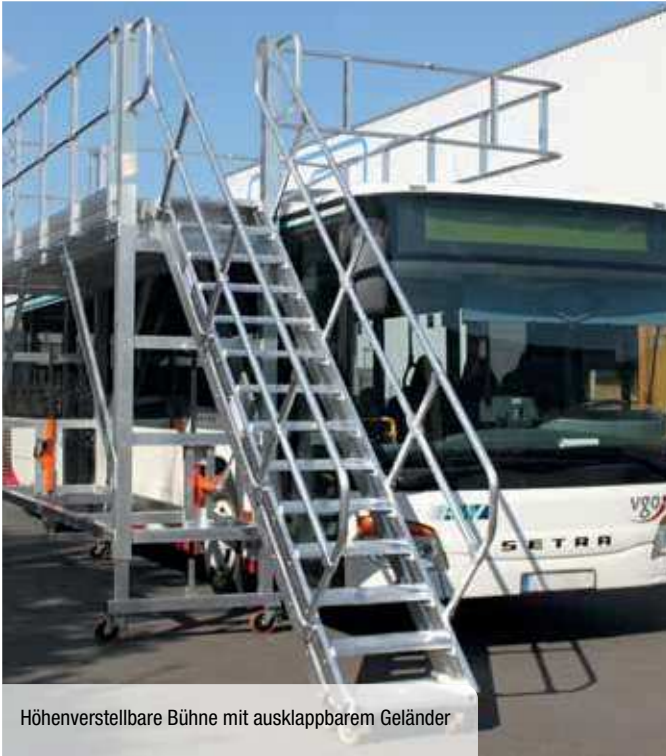
Fahrbare Montagebühne mit Klappgeländer
