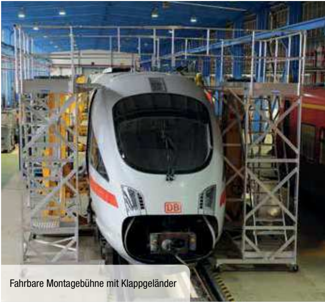
Laufboden mit Rammschutz und klappbarem Geländer
