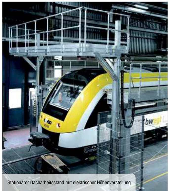
Laufboden mit Rammschutz und klappbarem Geländer
