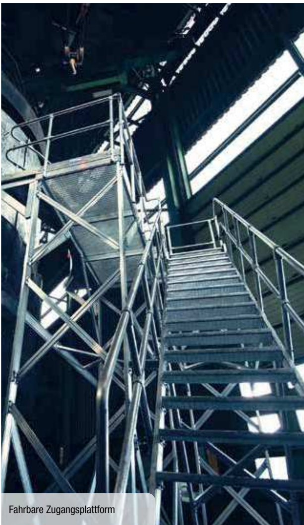
Fahrbare Arbeitsbühnen mit pulverbeschichteten Geländern
