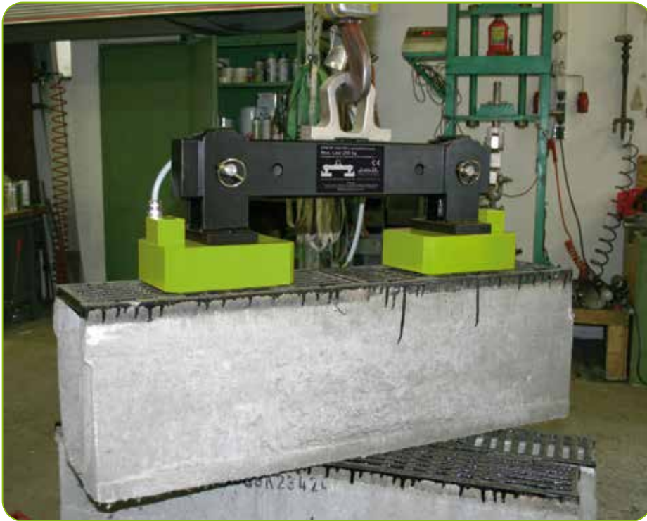
FXE-T Elektro-Permanent Tieffeldtraverse
