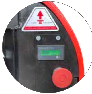
Batterieladestand- und Betriebsstundenanzeige mit Not-Aus-Knopf
