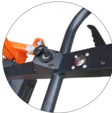
Deichsel mit Schlüsselschalter und Signallaste
