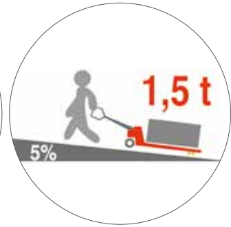
5% Steigfähigkeit bei Volllast
