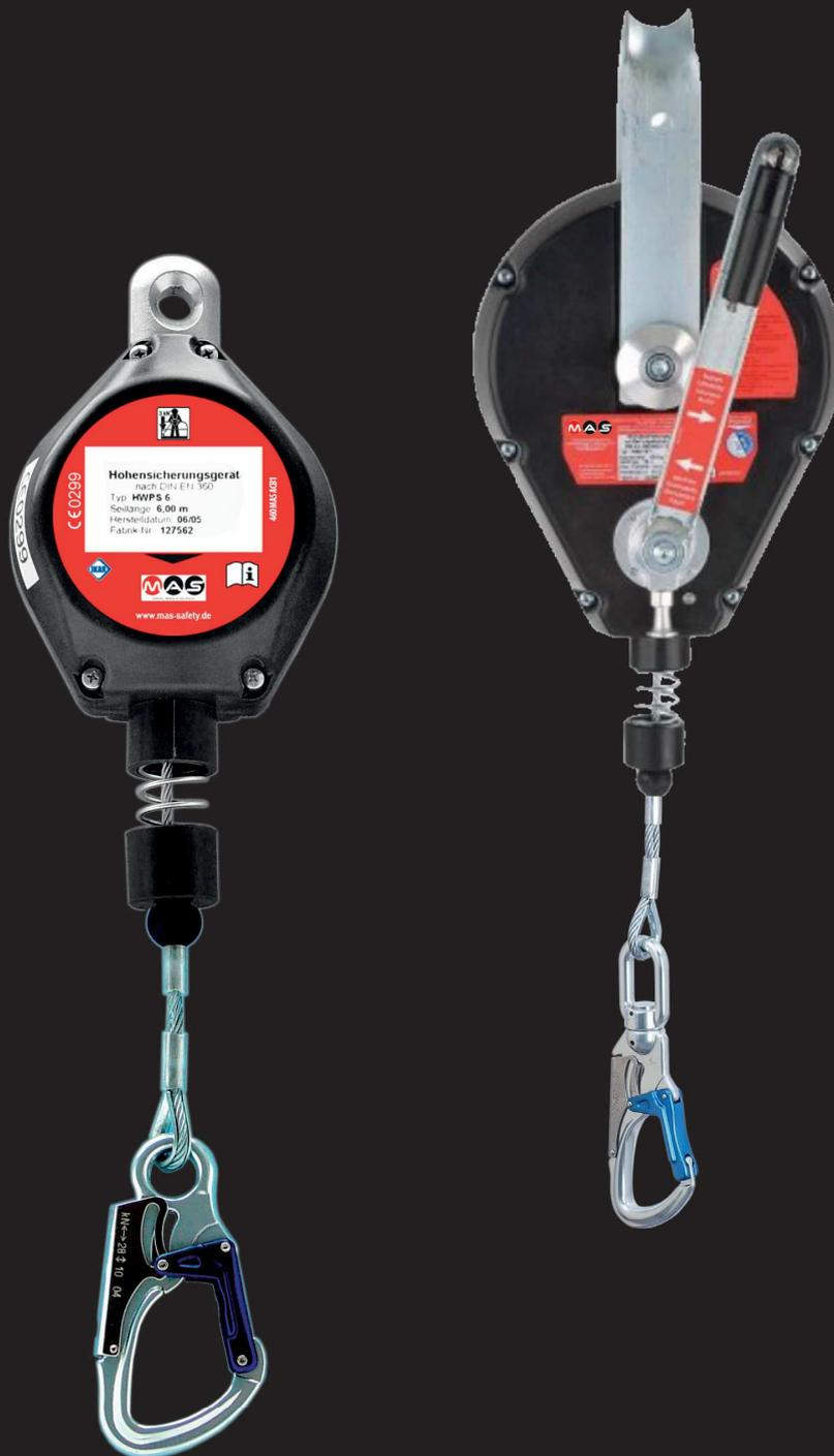
Das Hörsicherungsgerät ist ein Auffangerät mit einer selbsttätigen Blockierfunktion und einer automatischen Spann- und Einziehvorrchtung für das Verbindungsmittel, d.h. das einziehbarc Verbindungsmittel.
