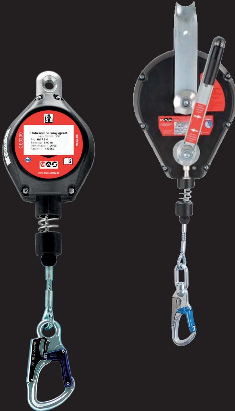
Das Hörsicherungsgerät ist ein Auffanggerät mit einer selbsttätigen Blockierfunktion und einer automatischen Spann- und Einziehvorrchtung für das Verbindungsmittel, d.h. das einzieh- bare Verbindungsmittel.
