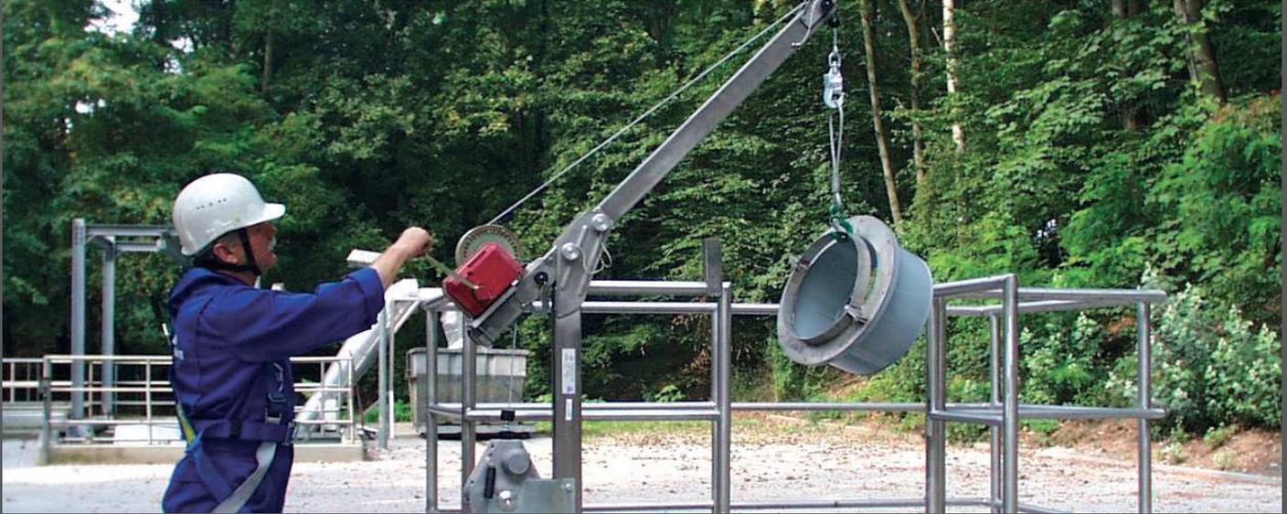
Der Auslegearm wurde speziell für den Einsatz von Höhensicherungsgeräten mit Rettungshubeinrichtung entwickelt. Er ist mit Boden oder Wandhülsen lieferbar. Der Auslegearm selbst ist mobil, d.h. er kann sehr schnell aus der Hülse gelöst und an einem anderen Ort eingesetzt werden. Der Auslegearm ist so konzipiert, dass zusätzlich zum Höhensicherungsgerät noch eine Lastwinde montiert werden kann.
