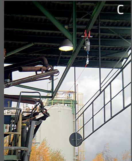
Durch den Einsatz auf handelsüblichen Stahlträgern (z.B. IPE 160 bis IPE 220) deckt der Rollwagen einen großen Einsatzbereich ab. Gerade bei Einsatzorten, die eine hohe Bewegungsfreiheit des Anwenders erfordern, bietet sich der Einsatz des RW1 geradezu an, da er als Anschlagpunkt für Höhensicherungs- und Abseilgeräte dient.
