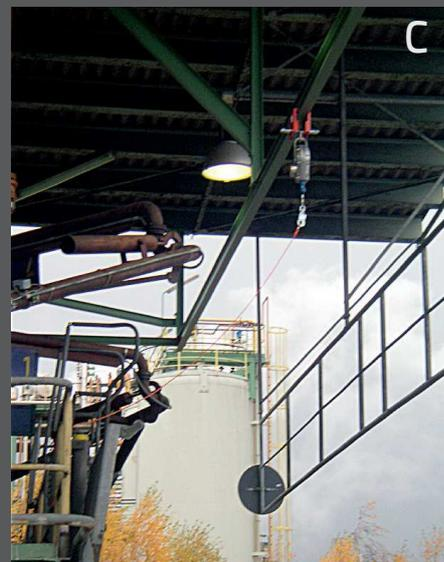
Durch den Einsatz auf handelsüblichen Stahlträgern (z.B. IPE 160 bis IPE 220) deckt der Rollwagen einen großen Einsatzbereich ab. Gerade bei Einsatzorten, die eine hohe Bewegungsfreiheit des Anwenders erfordern, bietet sich der Einsatz des RW1 geradezu an, da er als Anschlagpunkt für Höhensicherungs- und Abseilgeräte dient.
