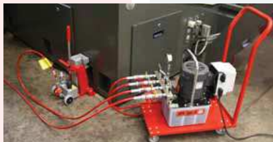
Elektropumpe JPE 30 NVR mit 2 Hebegeräten im Einsatz
