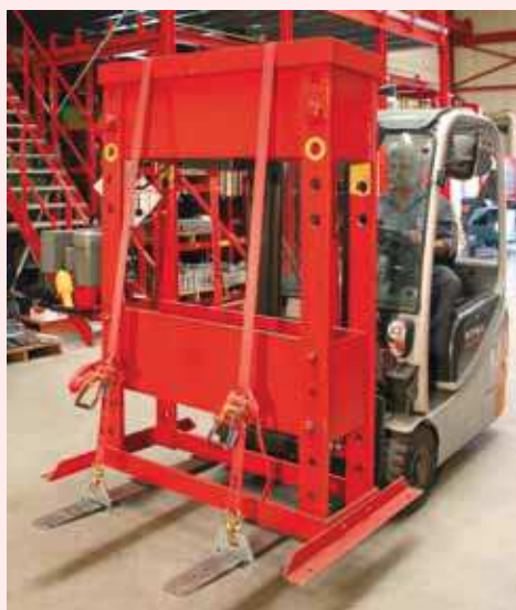
Ladungssicherung mit Gabelklemmen und Spanngurten
