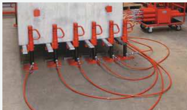
Sonderdruckblock zum synchronen Anheben mit 12 Hebegeväten Customised solution pressure block for lifting with 12 jacks
