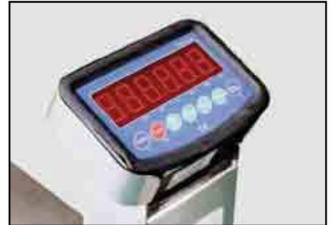
Das Gerät verfügt über eine 6V/ 4Ah Batterie und ein integriertes 7V/ 0,1A Ladegerät.
