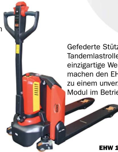
Gefederte Stützrollen, Tandemlastrollen und die einzigartige Wendigkeit machen den EHW 15 Premium zu einem unverzichtbaren Modul im Betrieb.
